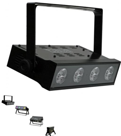
Proyector de LED muy potente basada en doce LED tricolor de 3 w, en 4 grupos que se controlan individualmente. Función maestro esclavo, autónomo o por audio con micro incorporado. Macros de color incorporados y atenuación automática con diferente velocidad. Lente de 45° estándar intercambiable por lentes de 30°, 60° ó 40° x 70°.
