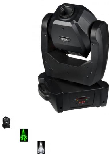
Cabeza móvil con LED de 60w SPOT, led de alta potencia y calidad. Gobos: Rueda de 6 gobos rotativos + abierto, efecto temblor. Rueda 8 colores + blanco. 0/100% regulación de intensidad. Posicionamiento automático. Pan / Tilt : 540° /270 °. Angulo: 15°. Lámpara: LED Blanco 60w. Control sonido : Micrófono interno. Función: Maestro / esclavo.
