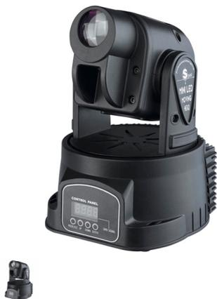
Mini Cabeza móvil compacta y ligera equipada con un Led de 3w. Posicionamiento exacto de 16 bits, Tilt 540° y 270° Pan. Rueda de 9 Gobos estáticos, más abierto. Efecto arcoiris con velocidad ajustable. Efecto estroboscópico de 1-10 flashes por segundo. Funcionamiento Maestro / esclavo, Dmx con cualquier controlador. Activación por audio a través de micro incorporado.
