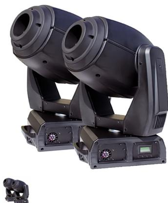
Basada en 3 LEDS Blancos de 60W. Enfoque electrónico. Ángulo : 18°. 11.000 Lux @ 2m. Rueda de 7 Gobos metálicos. Efectos Gobo Flow y Gobo Shake con rotación bidireccional. Rueda de 7 Colores dicroicos + Blanco. Efecto Arco-Iris. Display para configuración. DMX-512 18 ó 13 Canales. Dimmer 0-100%. Estrobo : 0-20Hz. Prisma rotativo de 3 caras. Pan 540° Tilt 270°. Resolución 8-16 bits.
