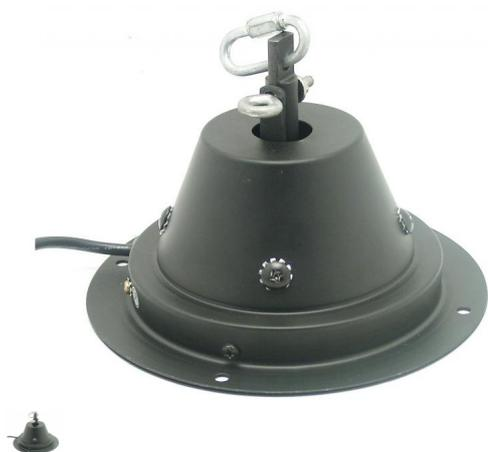
Fabricación de calidad, enteramente de acero Gran estabilidad gracias a la talla grande del eje motor Protección de seguridad mecánica cuando se rompe el eje motor Carga aprobada con una prueba de peso desacoplado Segundo ojete para colocar una cadena de seguridad suplementaria Concebido para las bolas de espejos de hasta 10 kg (cadenas incluidas)
