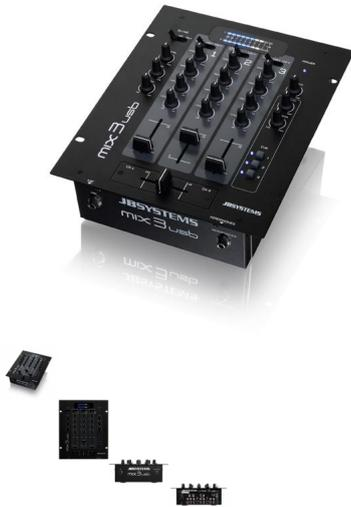
Mesa mezcladora con 9 entradas sobre 4 canales, 2 conexiones USB bidireccionales y entrada de micro independiente con talkover. Dispone de control de ganancia, agudos, medios y graves sobre todos los canales. Crossfader asignable y reemplazable además de potenciometros tipo "Steel Carril" y "Pre-Fader".
