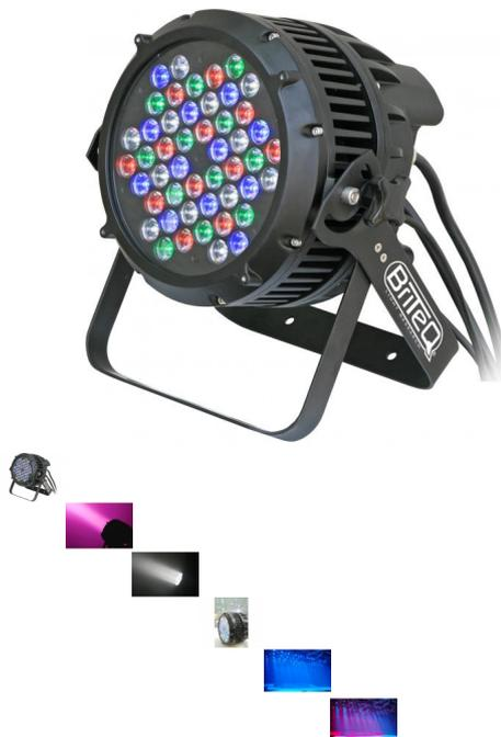
Proyector de LED RGB IP-65 , 48 LEDS 3w, 400Hz. Micrófono. Función: Maestro / esclavo, programas internos. Conector: XLR 3 pin M / H. Apertura: 15°. Lámpara: 48 x 3w ( 12-R, 12-V, 12-A, 12-B ) LUX: 16300 a 2m. Control: PB-01.
